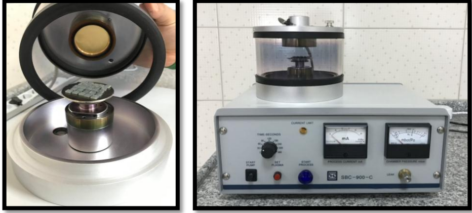
Resim 3.20. Hazırlanan örneklere altın kaplama uygulanması
