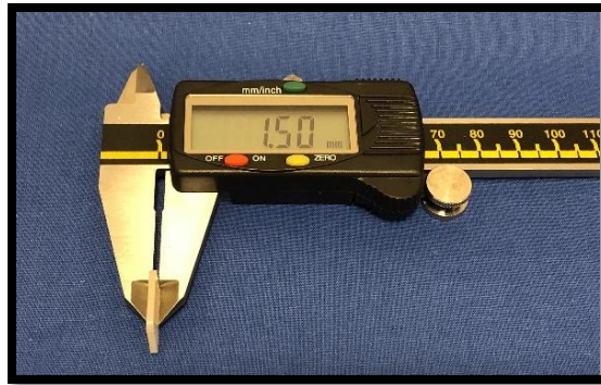
Resim 3.4. Örnek kalınlıklarının dijital mikrometre ile ölçülmesi
