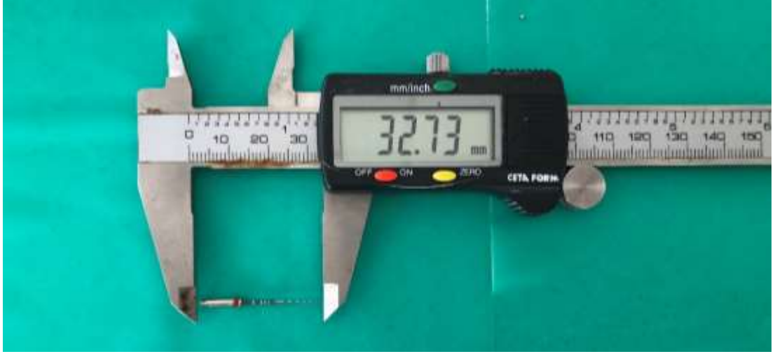
Şekil 19. Dijital kumpas kırık parça uzunluğu ölçümü yapılması.
