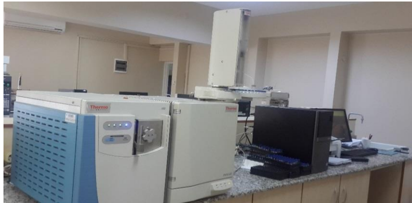
Şekil 6. Çalışmada kullanılan GC-MS cihazı
