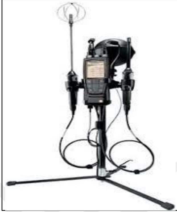
Şekil 3.19: Termal konfor ölçümlerinde kullanılan cihaz
