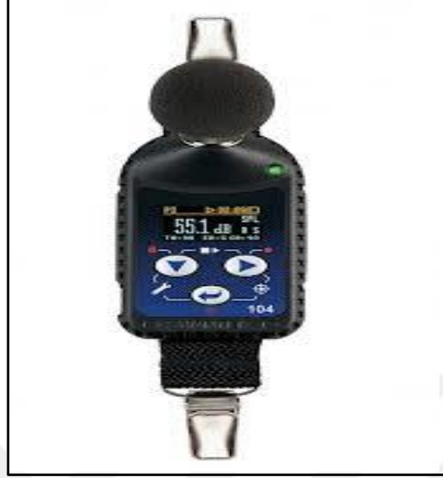
Şekil 3.7: Kişisel gürültü maruziyeti ölçümünde kullanılan cihaz
