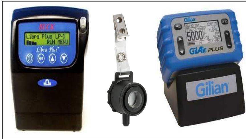
Şekil 3.20: Toz ölçümlerinde kullanılan cihazlar
