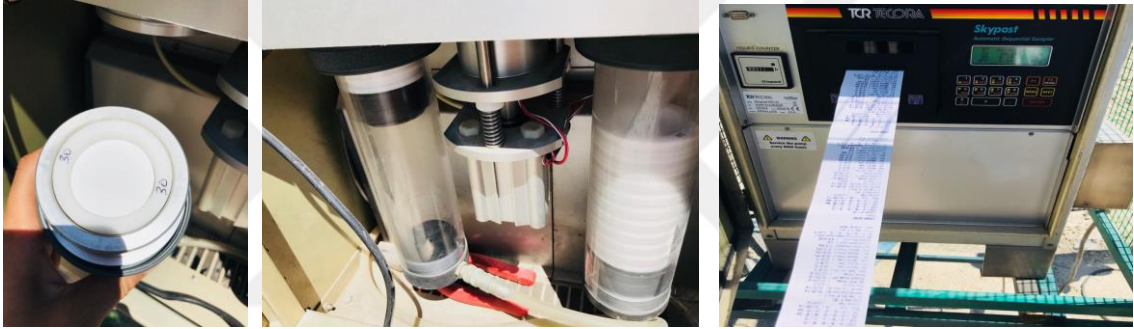
Şekil 20. Tecora cihazlara kasetlerin yüklenmesi ve ölçüm sonuç çıktılarının alınması
