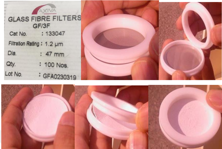
Şekil 24. Ölçümlerde kullanılan filtre kağıtları ve cihaz kasedine yerleştirilmesi
