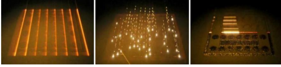
Şekil 2.10. EBM'deki temel işleme adımlarının fotoğrafları; (a) toz ön ısıtma, (b) çok ışınlı mod kullanılarak bileşen çevresinin (kontur) eritilmesi ve (c) tarama [16].
