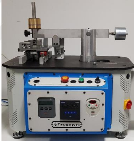
Şekil 3.15. TURKYUS RTW Lineer Aşındırma Cihazı
