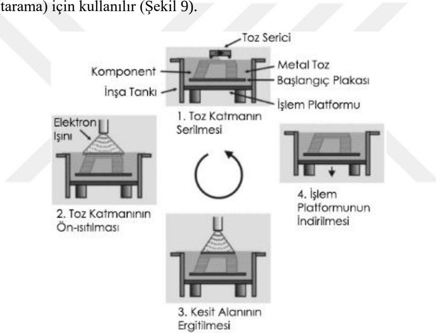
Şekil 2.9. Seçici elektron demeti ergitmede kullanılan işlem aşamalarının sıralı gösterimi, ilave katman imalatı [17].
