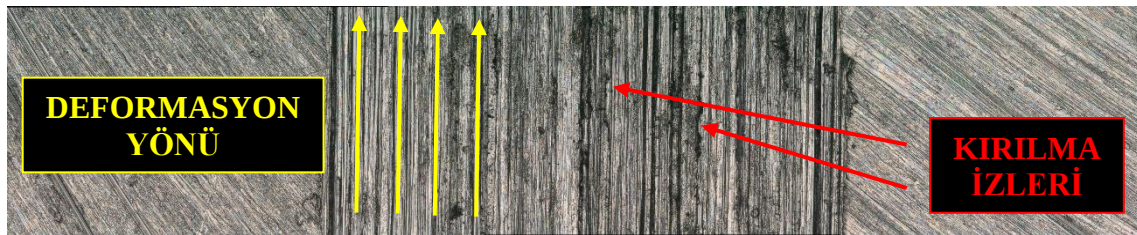
Şekil 4.45. Aşınma testi sonucu parçada meydana gelen deformasyon ve kırılma izleri.
