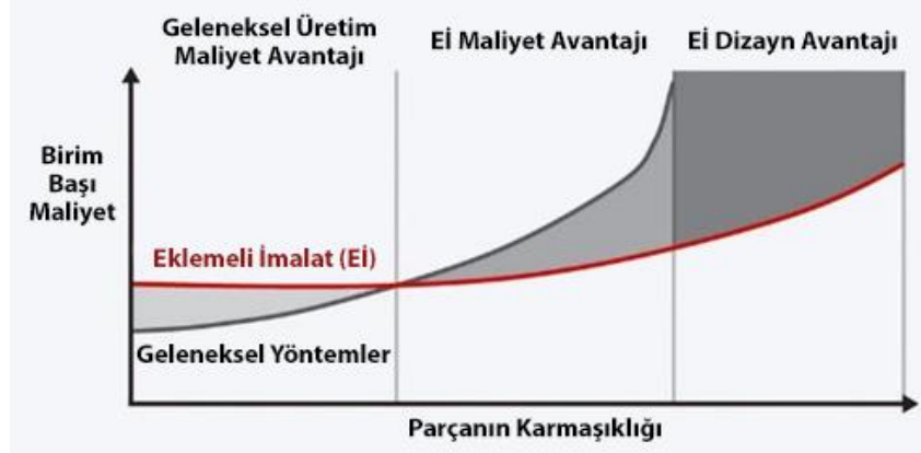
Şekil 2.3. Eklemeli imalatın, geleneksel yöntemlere göre komplekslik - hacim avantajları ve kırılma noktalarından sonraki kısıtlamaları [6].
