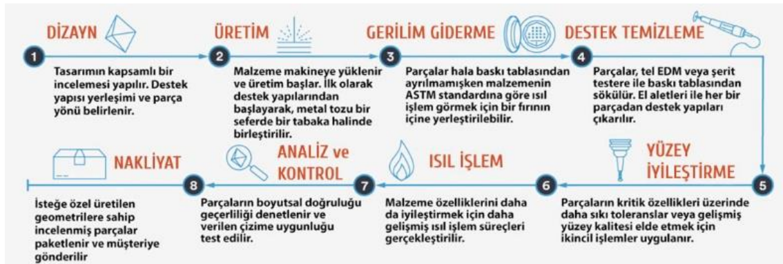
Şekil 2.2. Metal eklemeli imalatta genel iş akışı [5].
