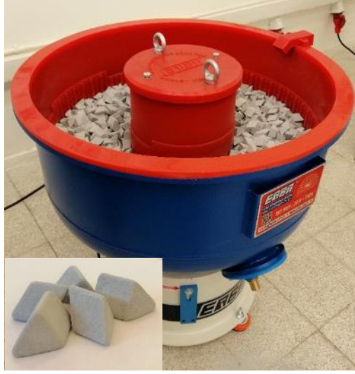
Şekil 3.5. ERBA ETP-100 vibrasyonlu yüzey işlem cihazı ve seramik aşındırıcı taşlar.
