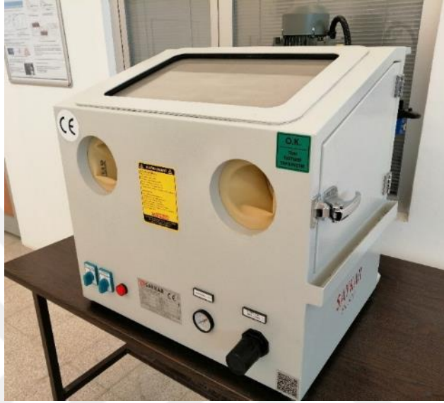
Şekil 3.4. Saykar SK-500 model tezgah üstü kumlama makinesi.
