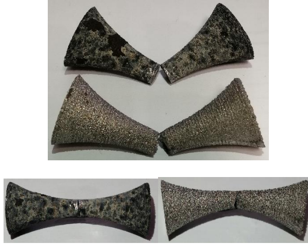
Şekil 4.41. En sünek ve en gevrek davranış gösteren işlem görmemiş ve HT-2 ısıtıl işlemi görmüş parçaların görselleri.
