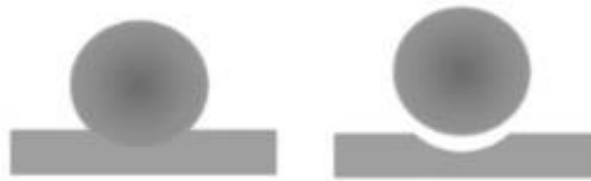
Şekil 4.42. Tez çalışmasında yararlanılan aşınma oranı hesabı formülünde tercih edilen bilye aşınmasının olmadığı durumu açıklayan görsel.
