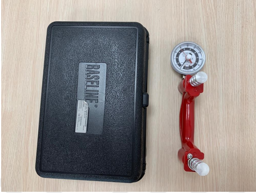
Şekil 3.7.5.1.1 Kullanılan Jamar Hidrolik El Dinamometresi
