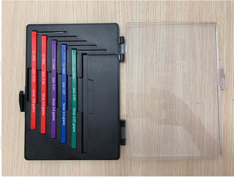
Şekil 3.7.4.1.3.1 Hafif dokunma değerlendirmesinde kullanılan monofilamentler
