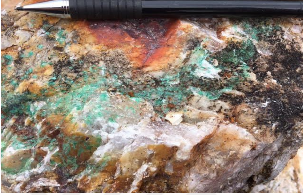
Şekil 4.45 : Barit'çe zengin cevher örneğinde,olasılıkla kalkopiritin oksitlenmesi sonucunda oluşan malahit sıvamalarının görünümü.
