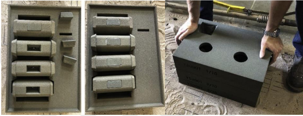
Şekil 2.16 : 3 boyutlu yazıcı ile üretilmiş kum kalıp [45].
