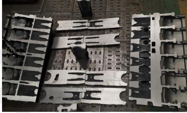
Şekil 4.18 : X-ray kontrolü için dilimlenmiş motor bloğu.
