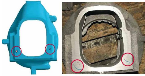
Şekil 2.18 : Simülasyon sonucu öngörülen çekinti riski ile döküm parçada gerçekleşen çekinti hatası gösterilmiştir [53].
