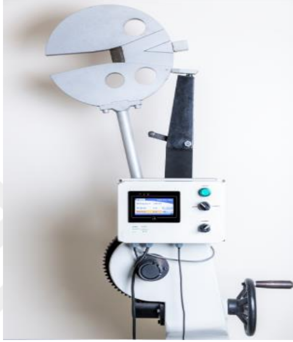
Şekil 3.11 : Çentik darbe testi yapılan ALŞA ZBC 300J markalı cihaz.
