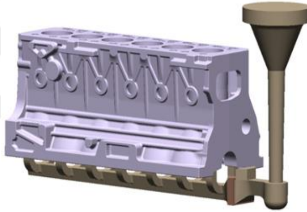
Şekil 4.1 : 1. versiyon simülasyon çalışması yolluk sistemi.
