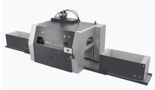
Şekil 3.3 : Maçaların yazdırılmasında kullanılan 3B kum yazıcı.
