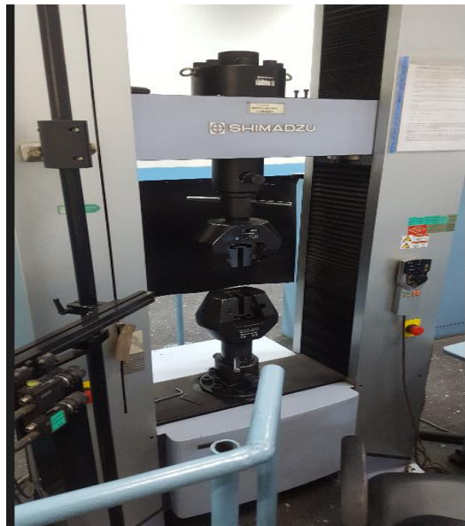
Şekil 3.10 : Çekme testi yapılan Shimadzu markalı cihaz.
