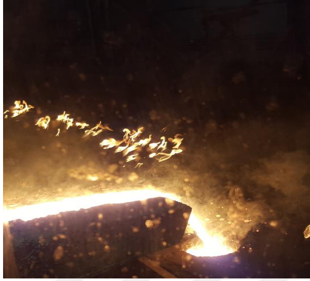
Şekil 3.8 : Sıvı metalin kalıba dökülmesi.
