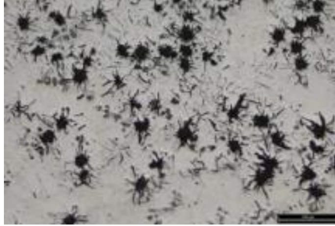
Şekil 2.6 : Benekli dökme demir mikroyapısı [22].
