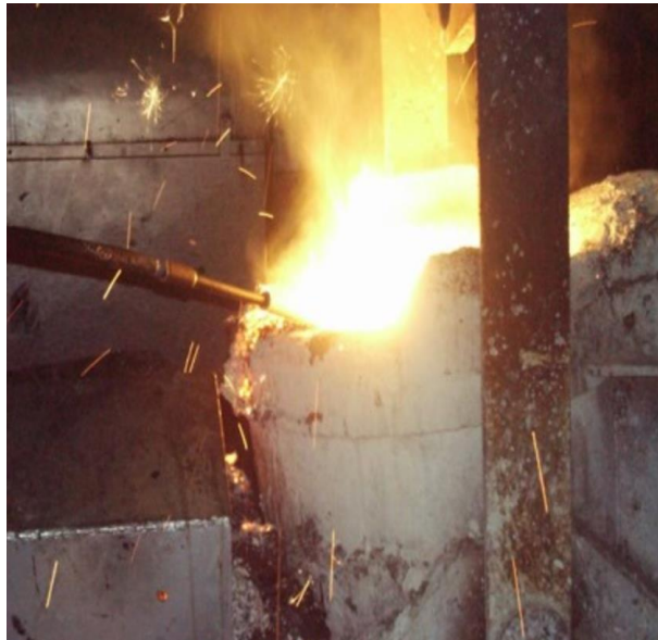
Şekil 3.7 : Sıvı metalin sıcaklığının ölçülmesi
