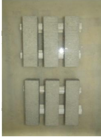
Şekil 7.12 Beton örneklerinin (16x4x4 cm 3 boyutlarında) su içerisinde bekletilmesi.
