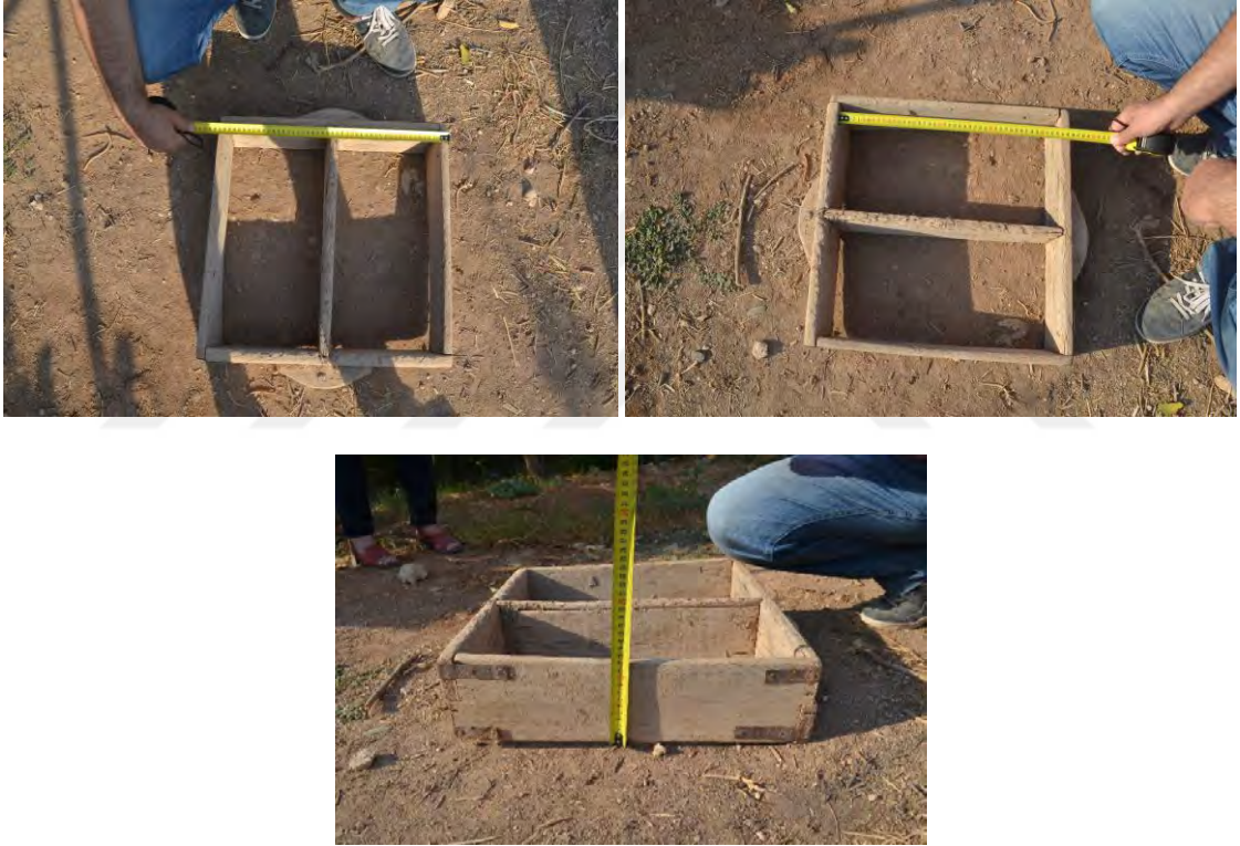
Şekil 5.90 Köyde yapılan 46x44x12 cm boyutlu kerpiç kalıbı, 2019
