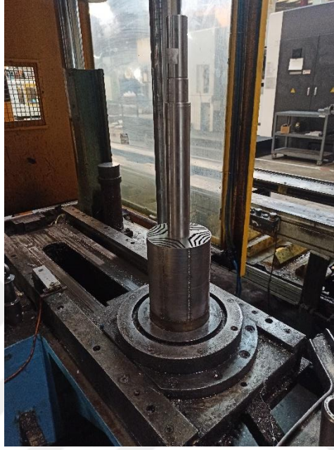
Şekil 7.3 Mil geçirme operasyonu
