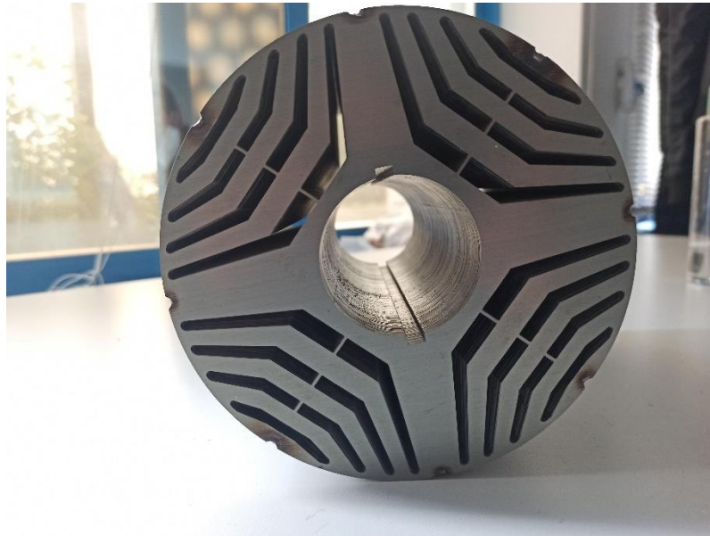
Şekil 7.2 Prototip motor rotor yapısı
