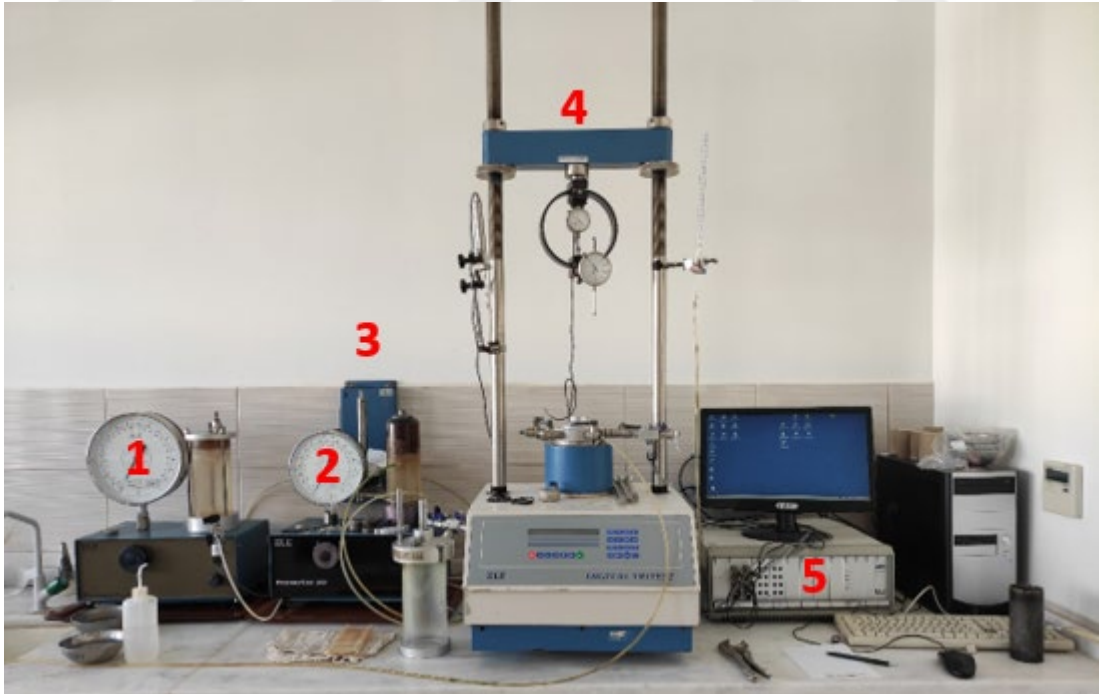
Şekil 3.3. Üç eksenli hücre kesme deney düzeneği
