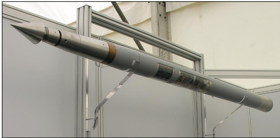
Şekil 1.5: Barracuda (Almanya) süperkavite torpidosu [32].
