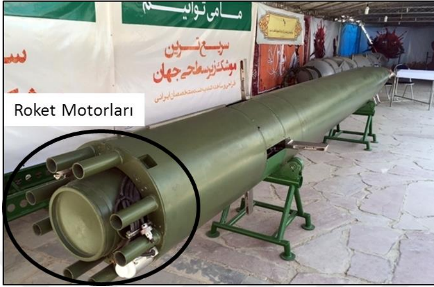
Şekil 1.4: Hoot (İran) süperkavite torpidosu [31].
