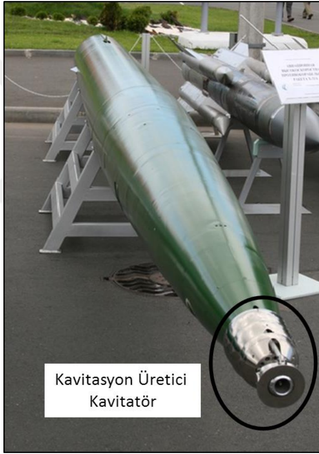
Şekil 1.3: Shkval-2 (Rusya) süperkavite torpidosu [30].
