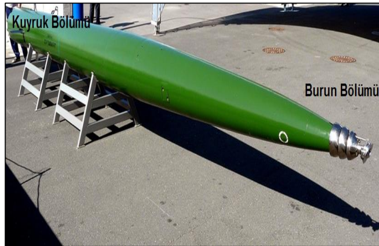
Şekil 1.2: Süperkavite su altı araçlarının genel geometrik görünümü [30].
