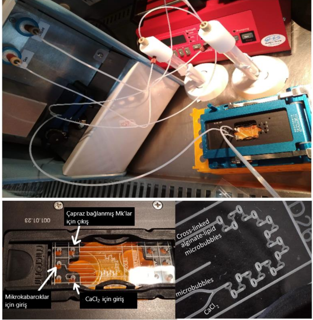
Şekil 3.6. MSC çıkışından gelen henüz-sentezlenmiş Al-Mk ve K-Al-Mk'ların \text{CaCl}_2 ile karıştırılmaları için kullanılan "teardrop" mikrokariştirici
