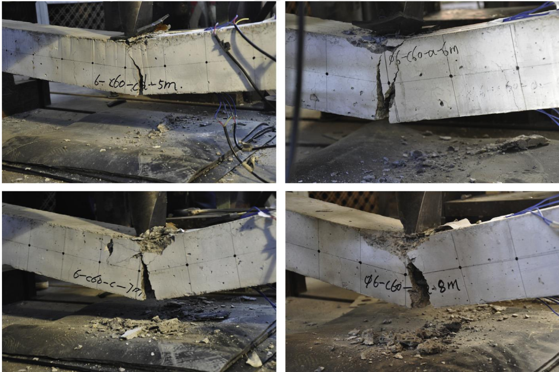
Şekil 1.6 5, 6, 7 ve 8 m Düşme Yükseklikleri İçin Kirişlerde Oluşan Çatlak Profilleri
