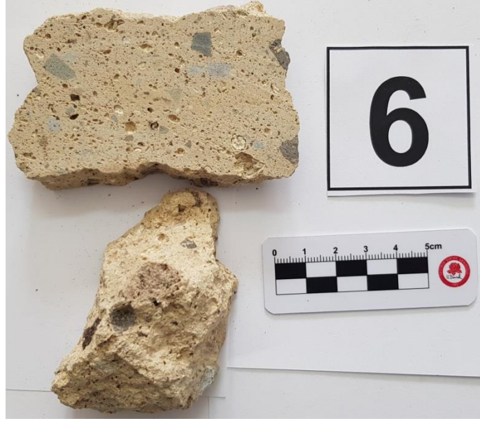
Şekil 4.11. Volkanik kayaç ve mineral parçalarından oluşan tuf
