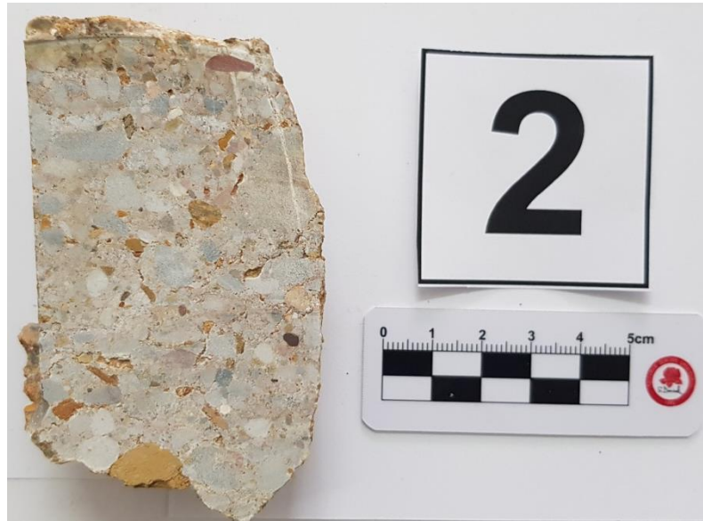
Şekil 4.9. Tanelerin kum matriksle tutturulduğu çakıltaşı görünümü.
