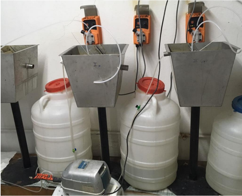
Şekil 3.10 CSTR sistemi genel görünüşü
