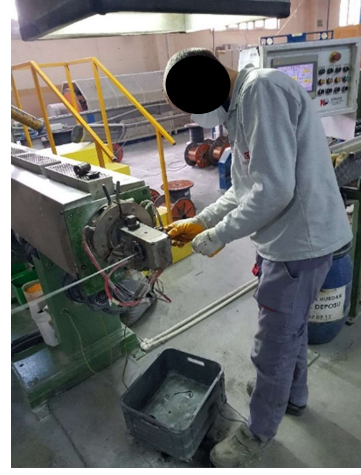
Şekil 3: Örgü prosesini tamamlamış kabloların dış kılıflama prosesinin kontrollerinin yapılması.
