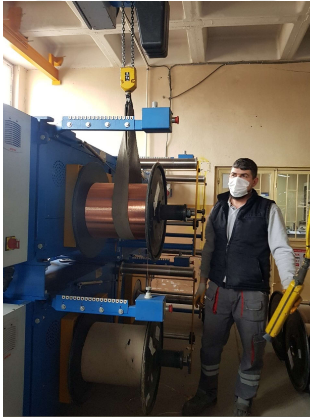
Şekil 6: Bakırın izolasyon makinesine tavan vinci ile yüklenmesi.
