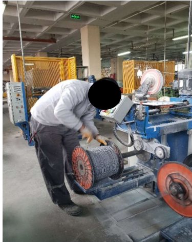
Şekil 2: Büküm prosesini tamamlamış kabloların iç kılıflama için makara halinde makineye yerleştirmesi.
