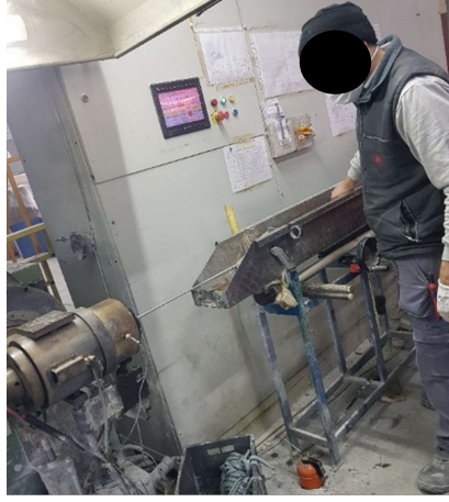
Şekil 3: Örgü prosesini tamamlamış kabloların dış kılıflama prosesinin kontrollerinin yapılması.
