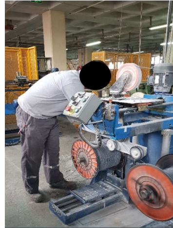
Şekil 2: Büküm prosesini tamamlamış kabloların iç kılıflama için makara halinde makineye yerleştirmesi.
