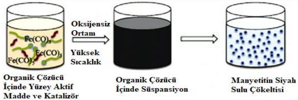
Şekil 2.7 : Manyetik nanopartiküllerin termal ayrışma yöntemi ile sentezlenmesi (Chaudhary ve Chaudhary, 2018)
