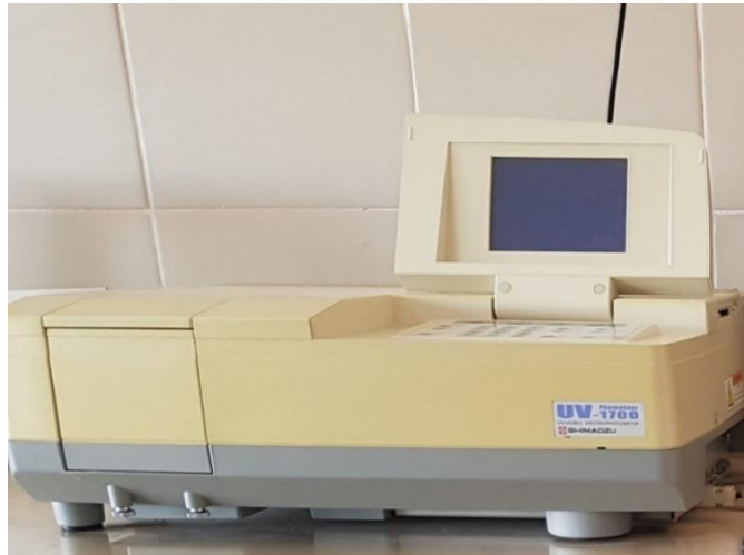
Şekil 3.9. AgNP sentez çalışmalarında kullanılan UV-Vis cihazı
