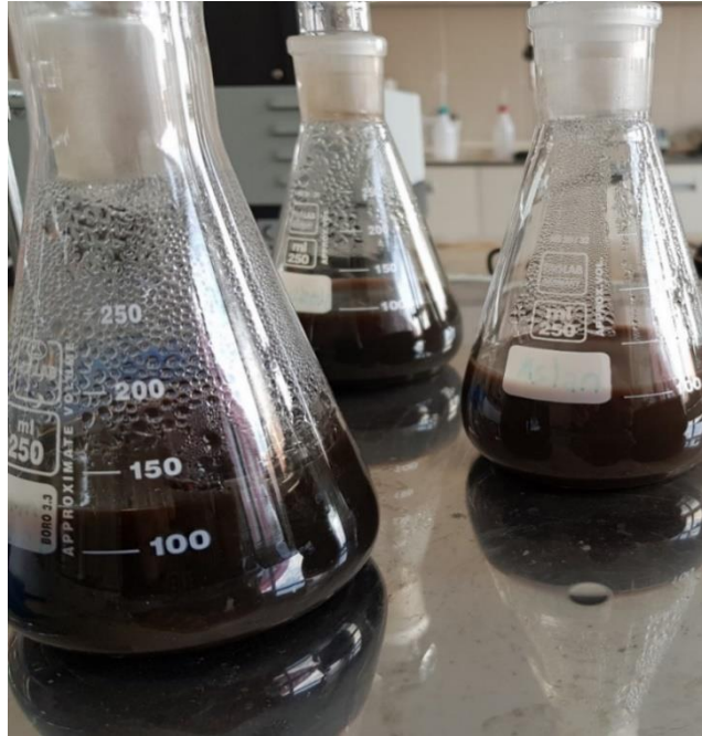
Şekil 3.7. Bitki ekstraktının \text{AgNO}_3 ile 24 saat karıştırılması sonucu oluşan çözelti
