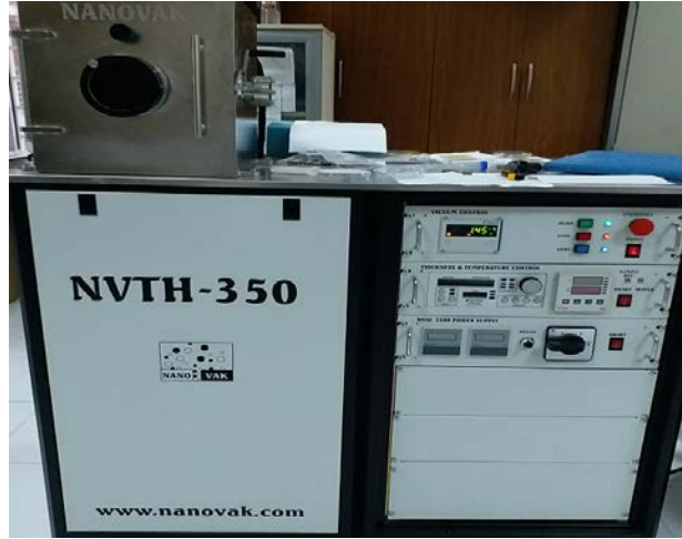
Şekil 2.5. Termal buharlaştırma (NVTH-350) sistemi (Batman Üniversitesi)
