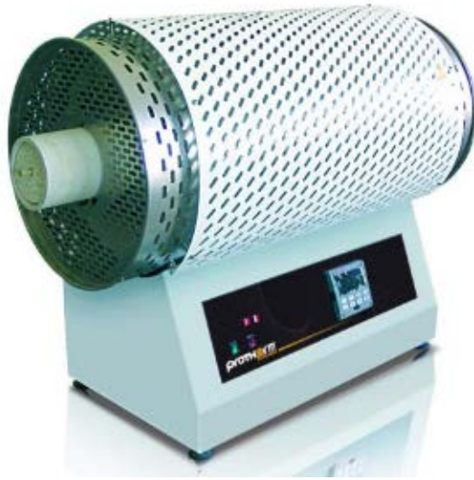
Şekil 3.2. 0-1200 °C ayarlanabilir protherm ptf 12/75/800 tüp fırın
