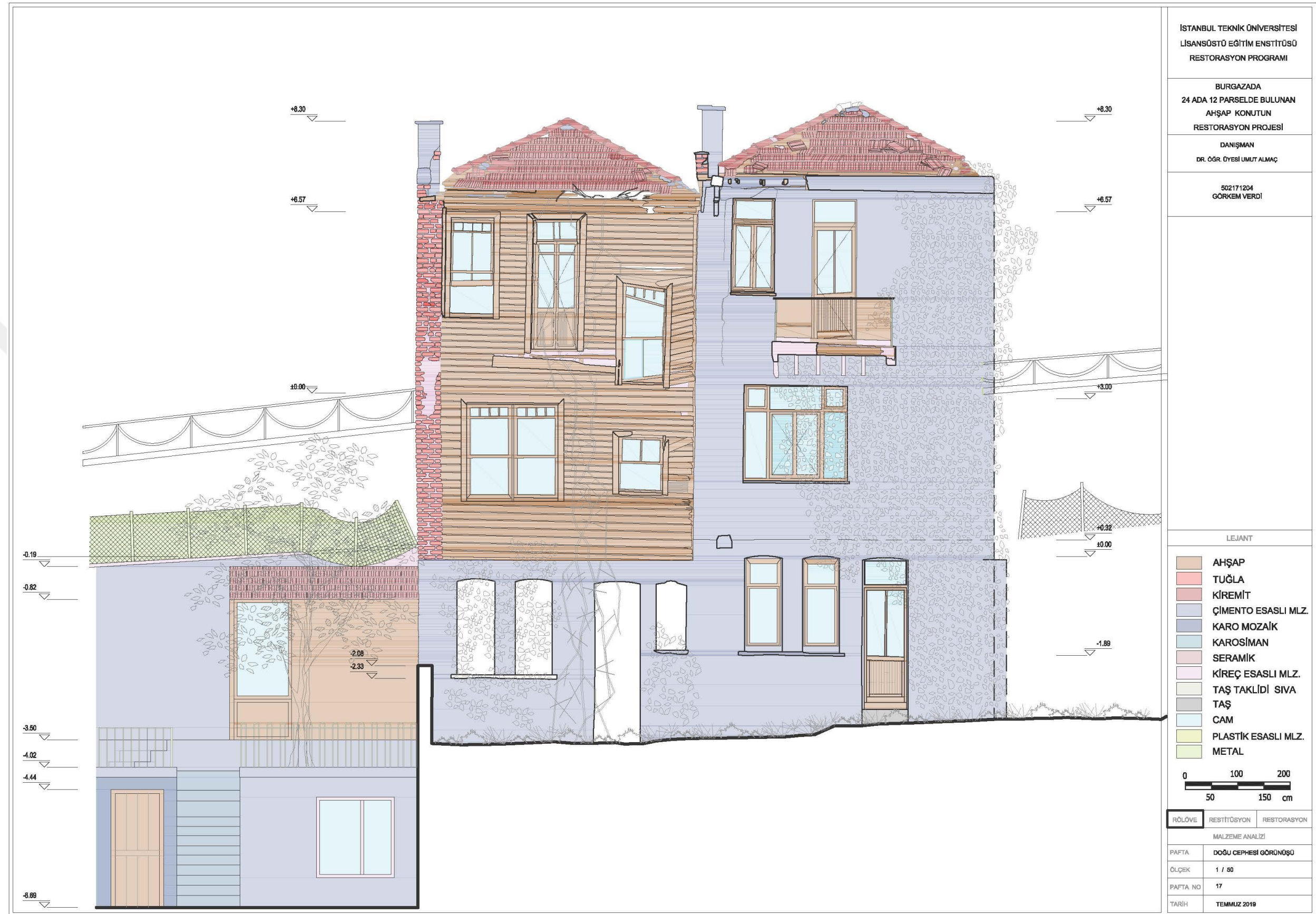
Şekil F.42: Malzeme analizi: Doğu cephesi.
