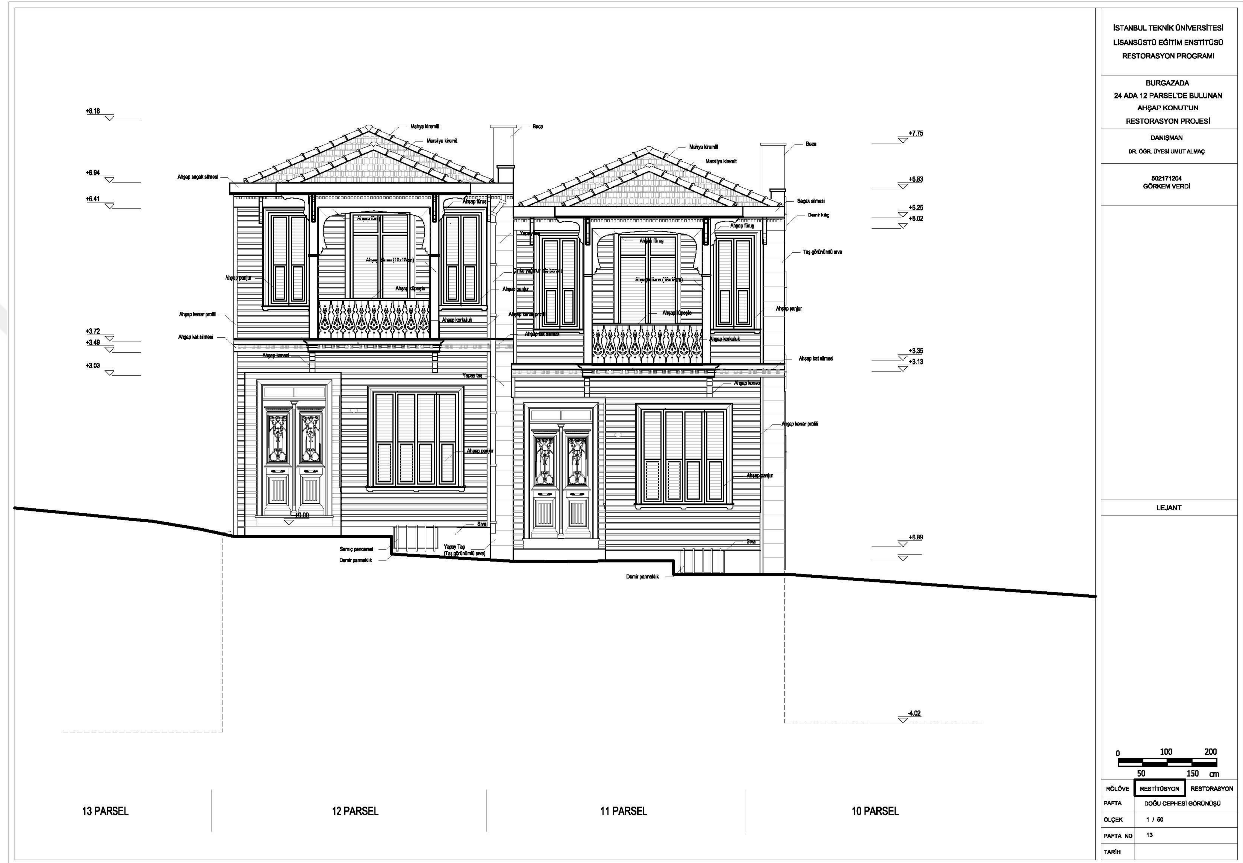
Şekil F.74: Restitüsyon: Batı cephesi.
