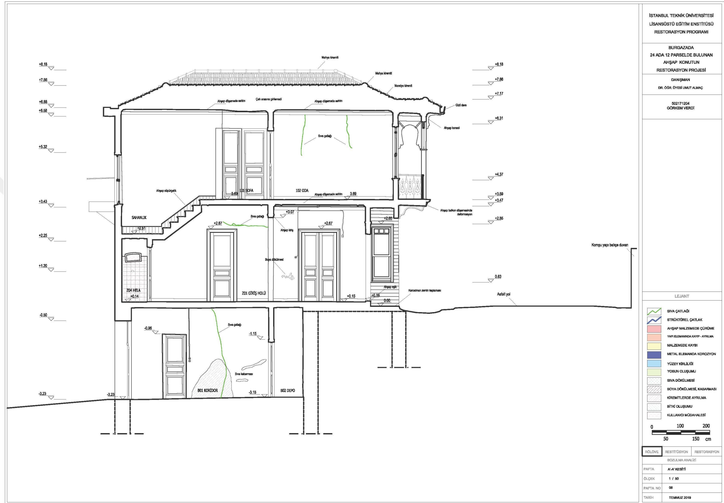
Şekil F.51: Bozulma analizi: A'-A' kesiti.
