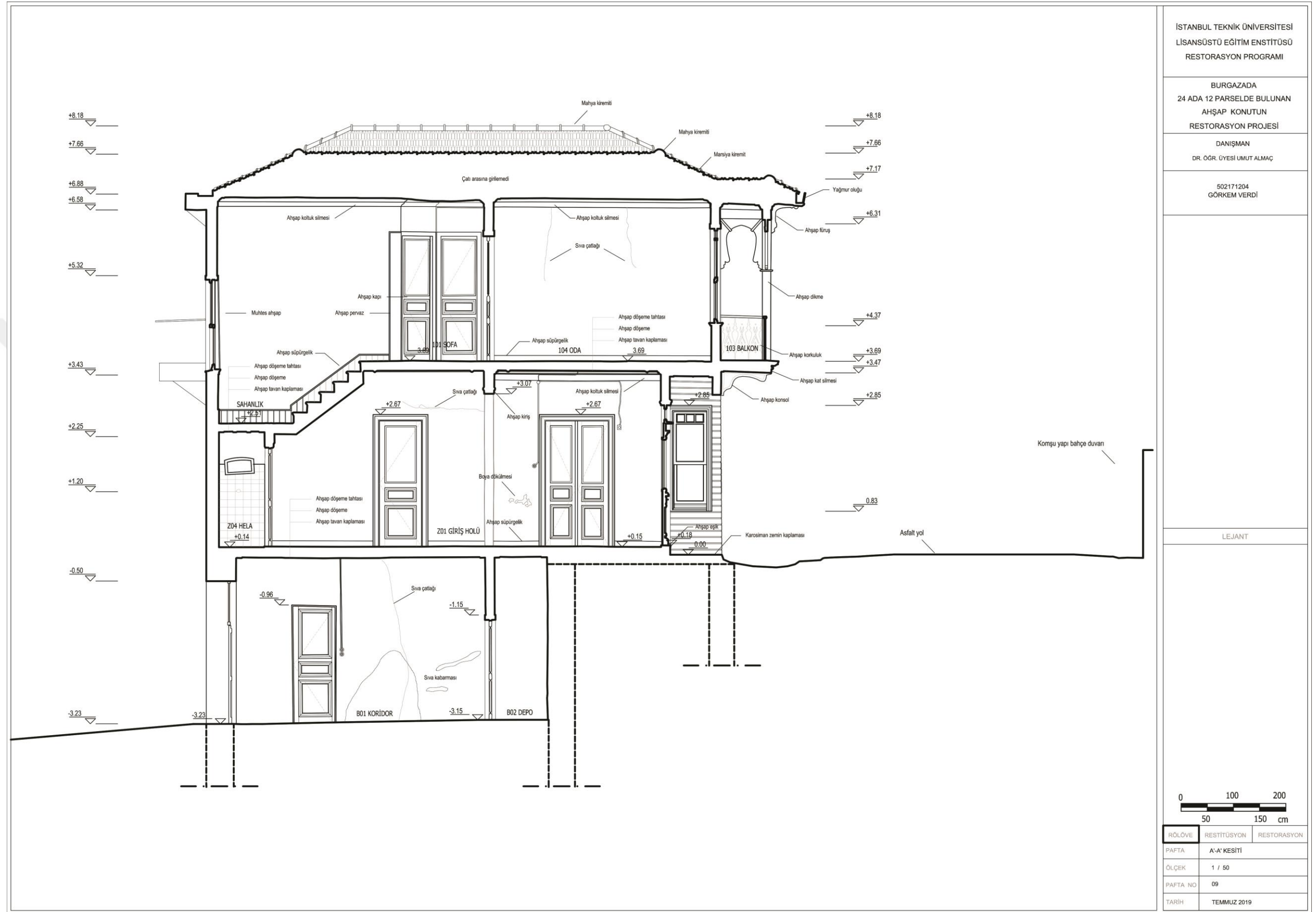
Şekil F.9: Rölöve A'-A' kesiti.
