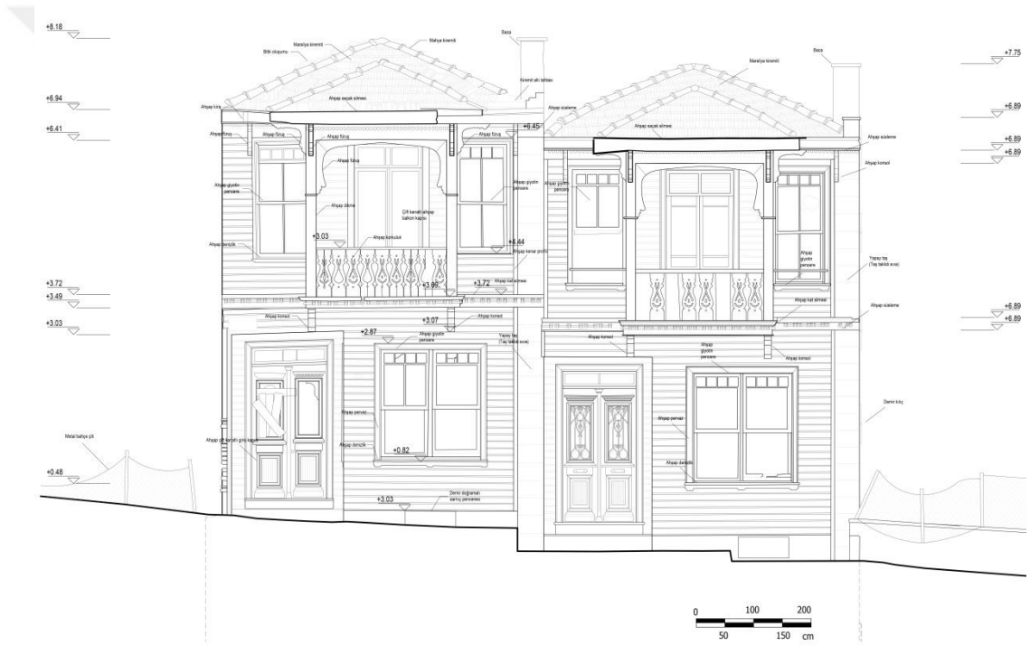
Şekil 3.6 : Batı cephesi görünüşü.
