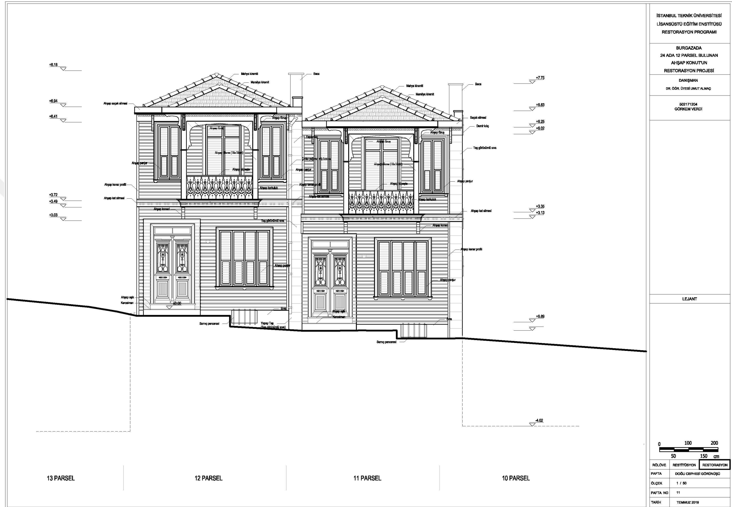
Şekil F.112: Restorasyon: Batı cephesi.
