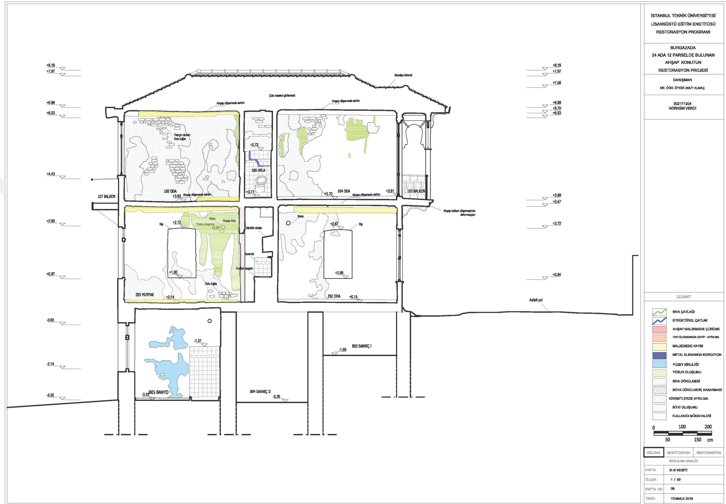
Şekil F.52: Bozulma analizi: B'-B' kesiti.
