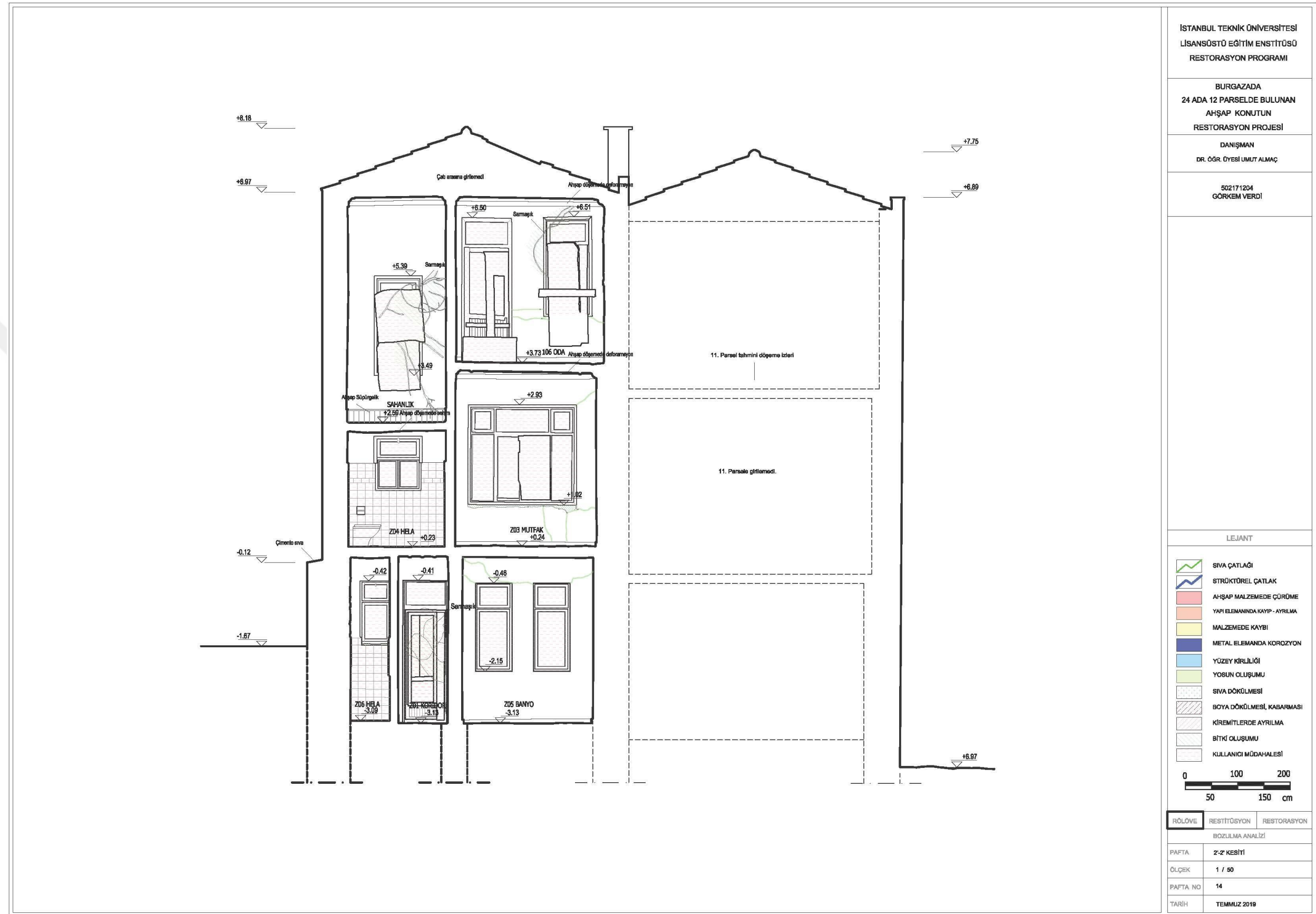
Şekil F.57: Bozulma analizi: 2'-2' kesiti.
