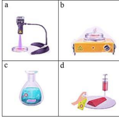
Şekil 2.9. Biyomürekkeplerin baskı öncesi, baskı anında veya sonrasında çapraz bağlama stratejileri; a) UV ışın maruziyeti, b) ısı değiştirme, c) daldırma, d) yüzey spreyleme (Aydın, Kucuk, & Kenar, 2020)
