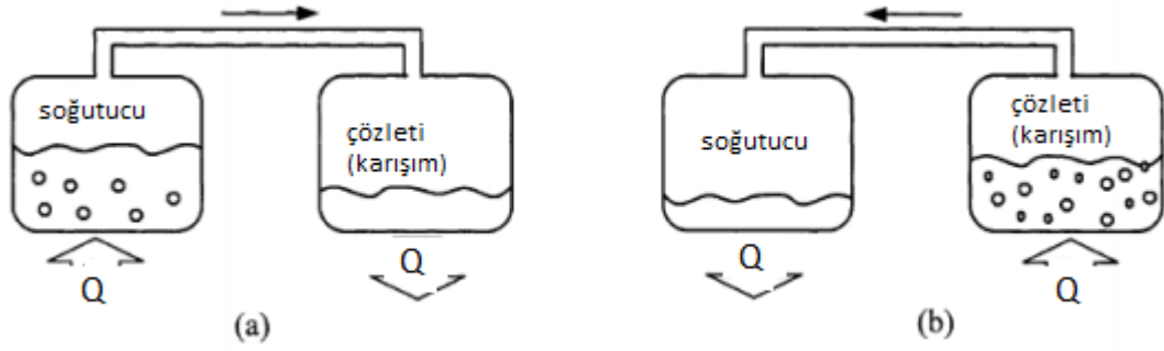
Şekil 2.2. Absorbsiyon ve soğutucu karışım ayırma prosesi [3]
