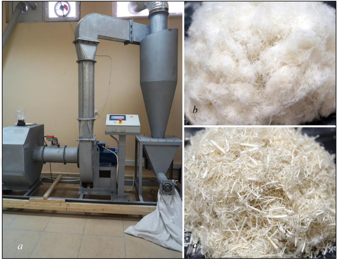
Şekil 2.9. a) ayırıştırma makinesi, b) tavuk tüylerinden ayırıştırılmış lifler, c) tavuk tüylerinden ayırıştırılmış sap materyali
