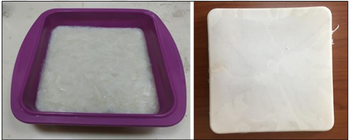
Şekil 2.13. Çözeltinin kalıba dökülmesi (solda) ve dondurulmuş numune (sağda)
