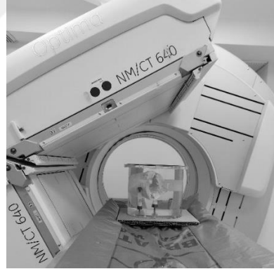
Şekil 49. Kardiyak insert fantomun miyokard görüntülemeye uygun sabitlenmesi
