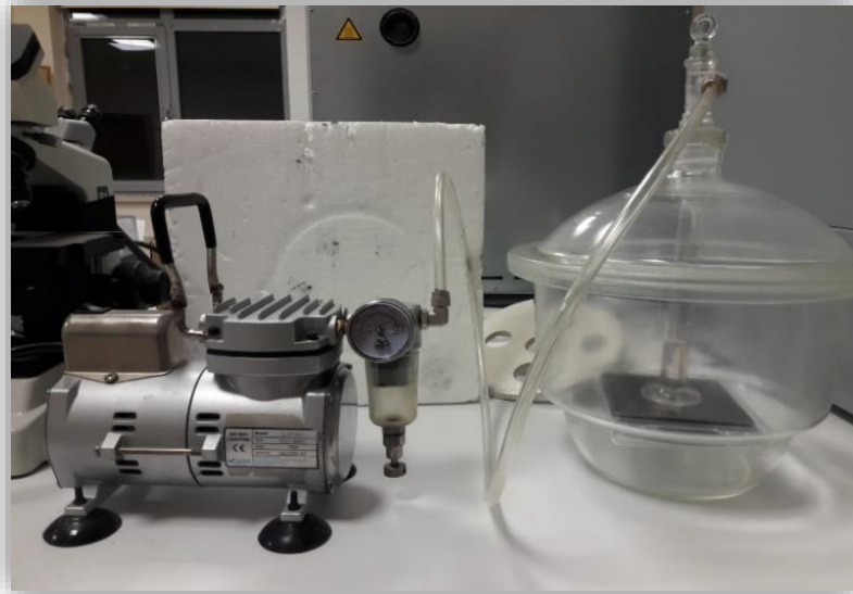
Şekil 6.5. Yoğunluk ve porozite ölçümü için kullanılan vakumlu desikatör.
