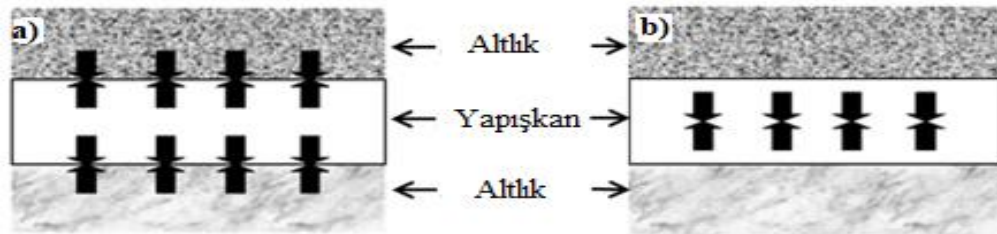
Şekil 2.8: a) Adeziv dayanım, b) Kohezif dayanımın şematik gösterimi [107].
