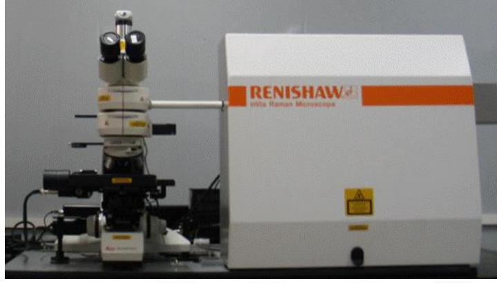
Şekil 6.9: Raman spektroskopisi cihazı.
