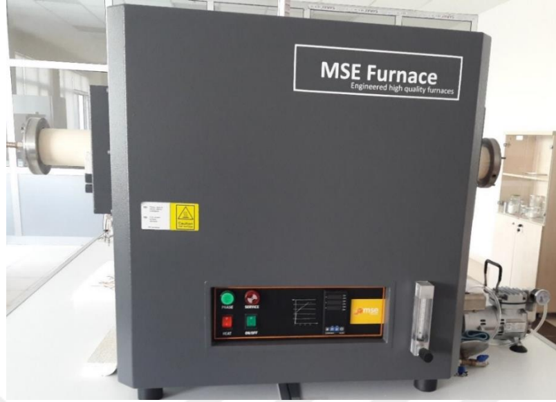
Şekil 6.4: Isıl işlemin gerçekleştirildiği tüp fırının görüntüsü.
