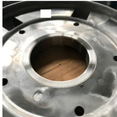
Şekil 4.4 Broşlama öncesi çapa hassas tornalanmış parça deliği
