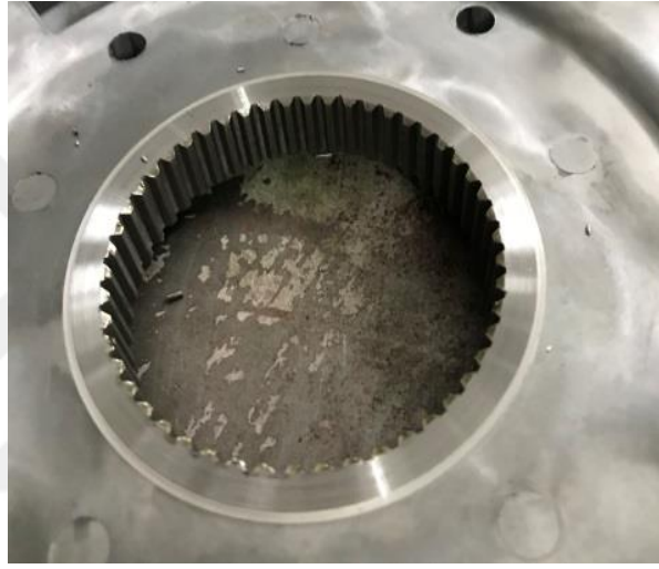
Şekil 4.7 Broşlama sonrası parça deliğinde oluşan evolvent formu
