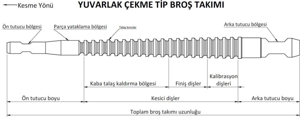
Şekil 2.2 Broş takımlarında fonksiyonel bölgeler
