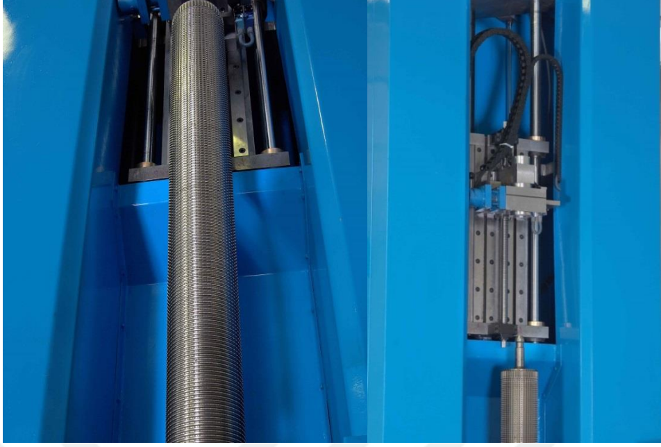
Şekil 2.7 Büyük çaplı bir broş takımının broş çekme tezgâhı üzerine konumlanması ve üst tutucu mekanizması [25]
