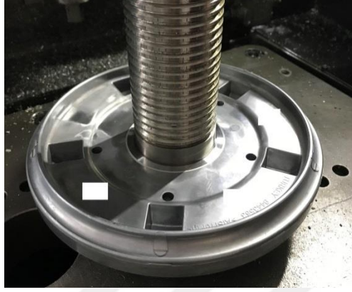
Şekil 4.5 Parçanın hassas tornalanmış delik çapından broş takımının ön şaftını yataklaması
