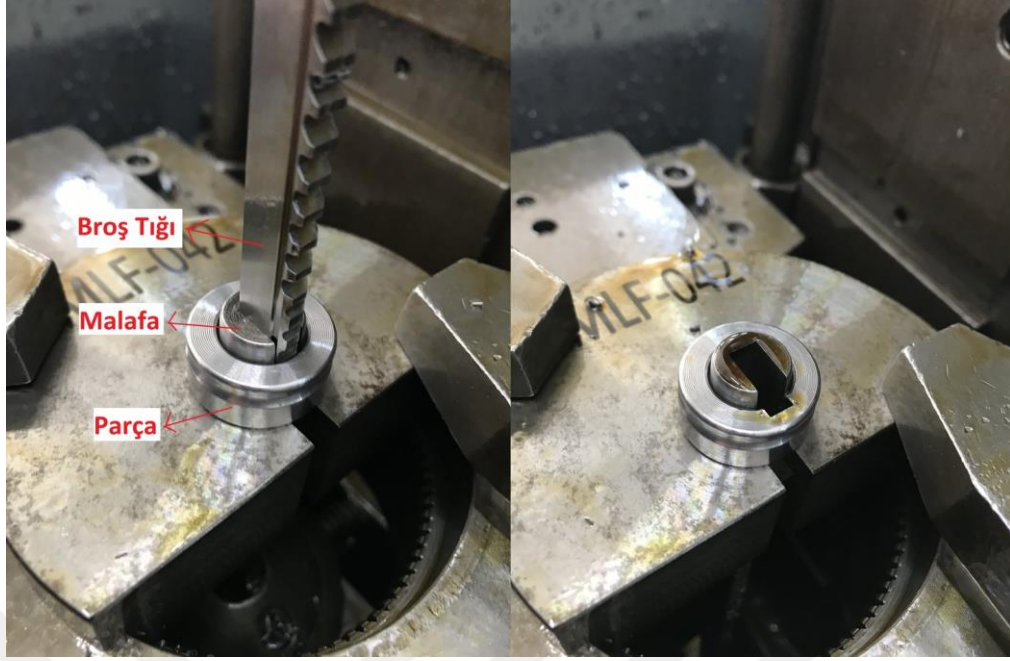
Şekil 4.10 Örnek bir kama broş takımı ile broşlama prosesi ve broşlama sonrası parça geometrisi
