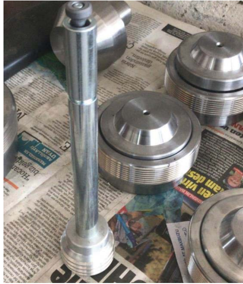
Şekil 3.13 Silindir içi bilyalı dövme aparatı
