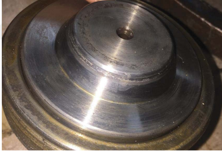
Şekil B. 7. Deney numunesinin sızdırmazlık kapağının aşınması
