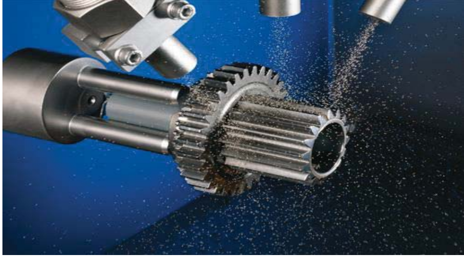
Şekil 2.7 Bilyalı dövme işlemi (Anonymous, 2019)
