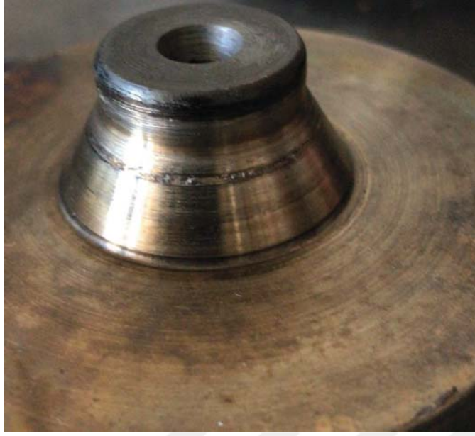
Şekil B. 6. BY'nin konik sızdırmazlık kapağının aşınması
