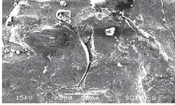
Şekil A.5. 255 HV’ye sahip numunede oluşan mikro çatlak görüntüsü (Torres ve ark. 2016)
