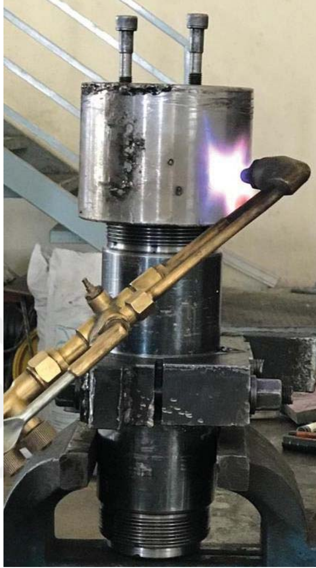
Şekil B. 2. Vidalarının açılması için uygulanan ısıtma yöntemi
