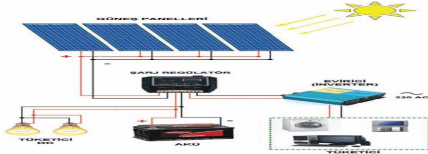
Resim 2.6 Şebekeden bağımsız pv sistem şeması [27]
