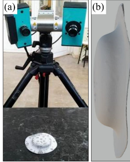
Şekil 4.11. 3B optik taramanın yapılması (a) optoTop-HE 3B optik tarama cihazında yapılan tarama işlemi (b) Katı modele çevrilmiş Ti-6Al-4V silindirik parça (Öztürk ve ark., 2024)
