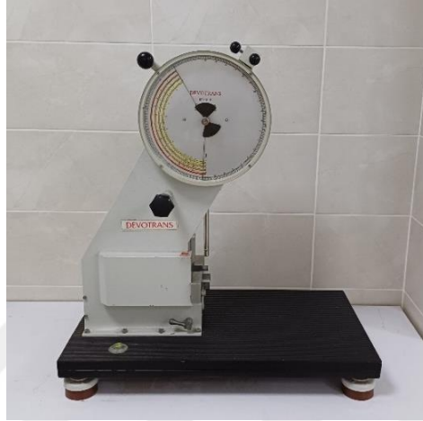
Şekil 3.17. Darbe direnci test cihazı.
