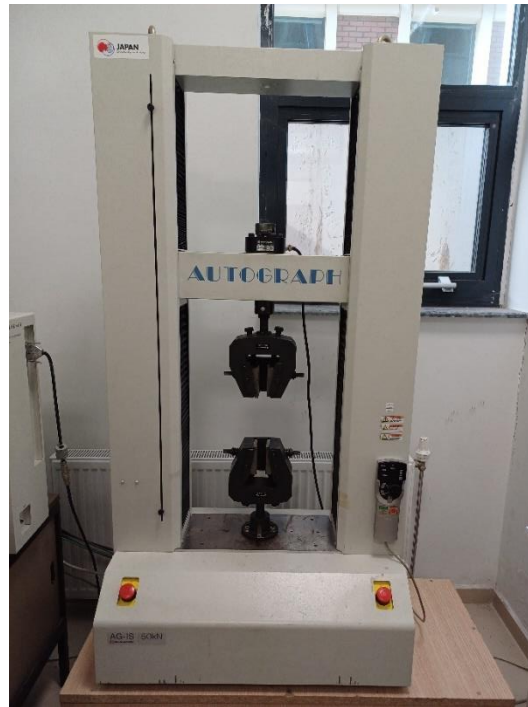
Şekil 3.15. Çekme direnci test cihazı.
