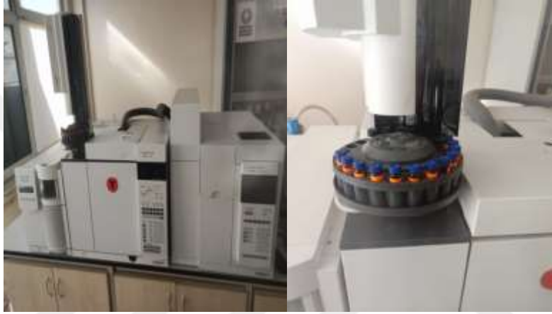
Şekil 3.14: GC/GC-MS cihazı ile uçucu yağ bileşenlerinin belirlenmesi.
