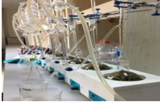
Şekil 3.13: Clevenger cihazında uçucu yağ oranları tespiti.
