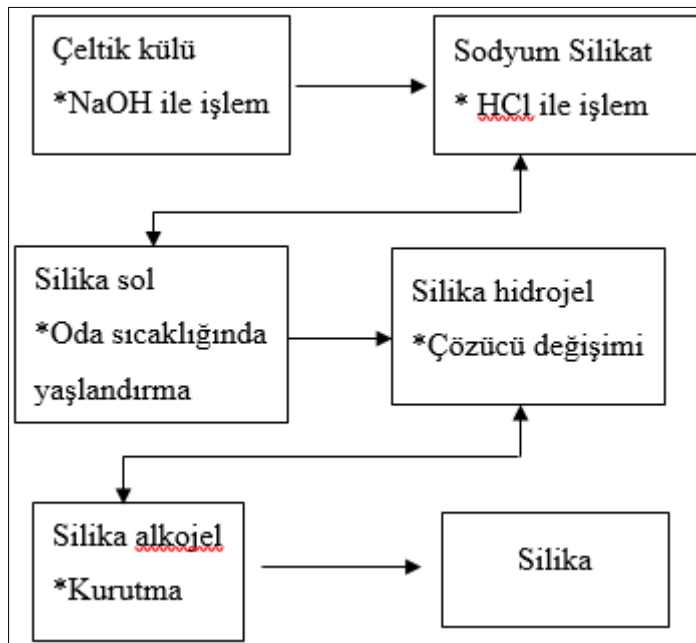
Şekil 4.1. Çeltik külünden silika eldesi
