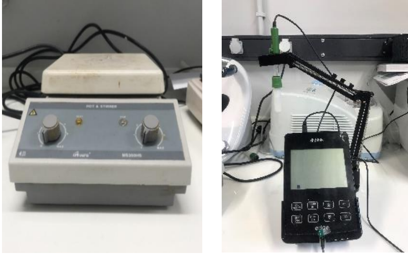
Şekil 3. 7 pH analizinde kullanılan manyetik karıştırıcı ve pH metre cihazı
