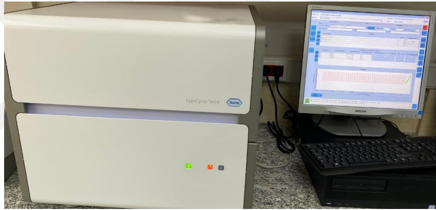
Şekil 3.4. Çalışmada kullanılan Roche LightCycler® markalı qPCR cihazı
