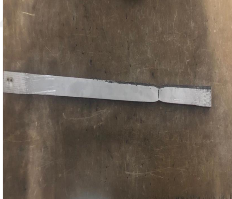
Şekil 3.5. Çekme işleminden sonra numunenin kopmuş hali
