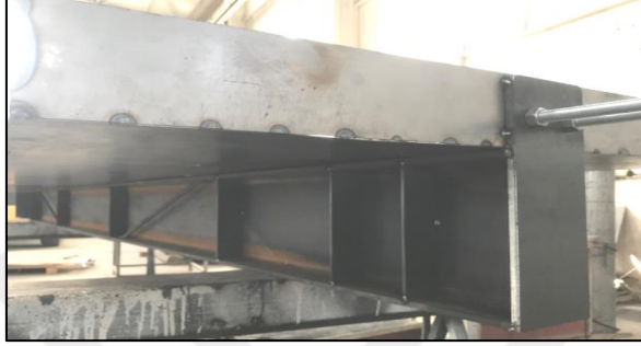
c. PSCCB örneğinde berkitme levhaları ve öngerme halatının konumlandırılması
