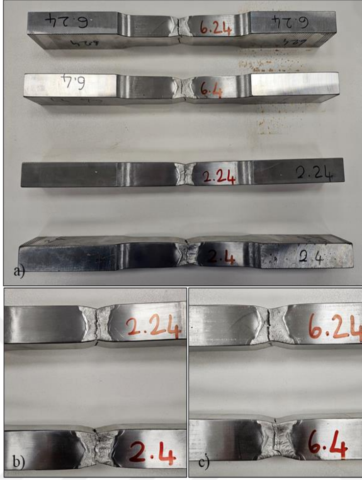
Şekil 6.5 : Çekme testi numuneleri. a) Test sonrası çekme testi numuneleri. b) Test sonrası doğrudan kaynaklı numune. c) Test sonrası ön ısıtma sonrası kaynaklanan numune.
