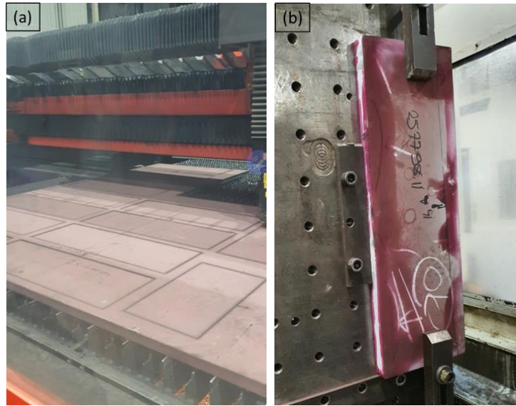
Şekil 5.1 : a) Lazer tezgahında plaka kesimi. b) CNC tezgahında kaynak ağzı hazırlığı.
