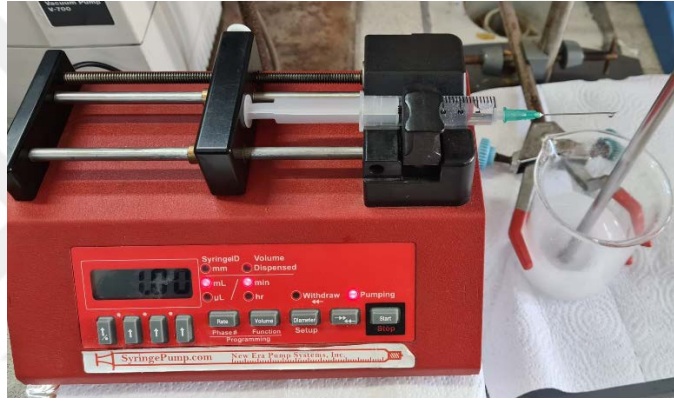
Şekil 3.16: Polimer ve ilaç çözeltisinin yağ faza şırınga pompası ile eklenmesi.
