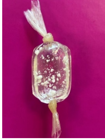
Şekil 3.25: Diyaliz membran ile gerçekleştirilen çözünme testi.
