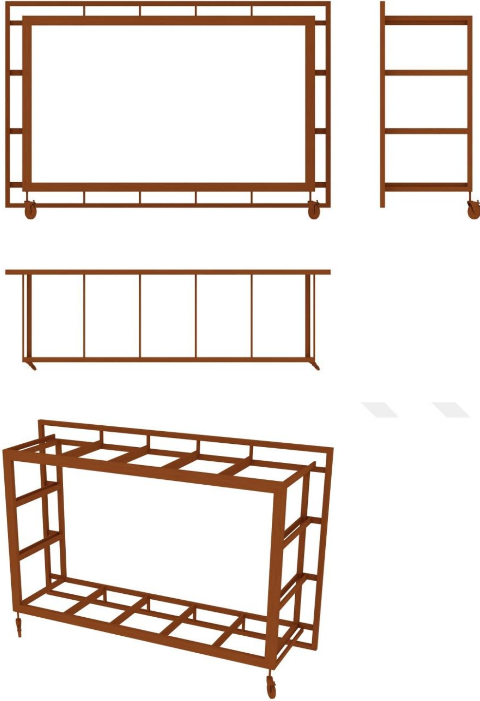
Resim 100: Esnek modül demir konstrüksiyonu ön, yan, üst görünüşü ve perspektifi
