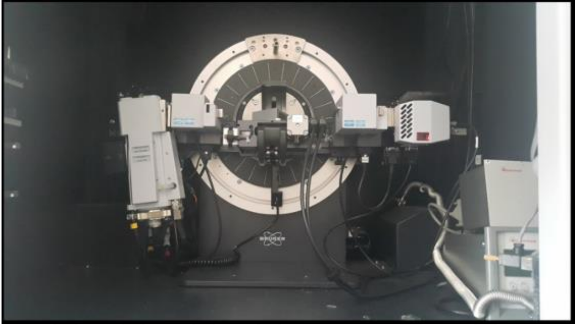
Şekil 2. 10. X-ışını kırınımı Difraktometresi (XRD) (Al-gburi, 2018)
