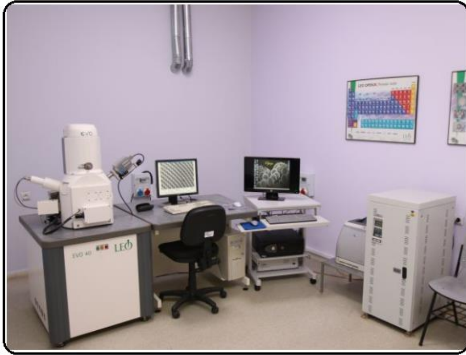
Şekil 3. 9. AgNP'lerin kimyasal kompozisyonlarını belirlenmesi için kullanılan SEM ile bağlantılı EDX cihazı görünümü
