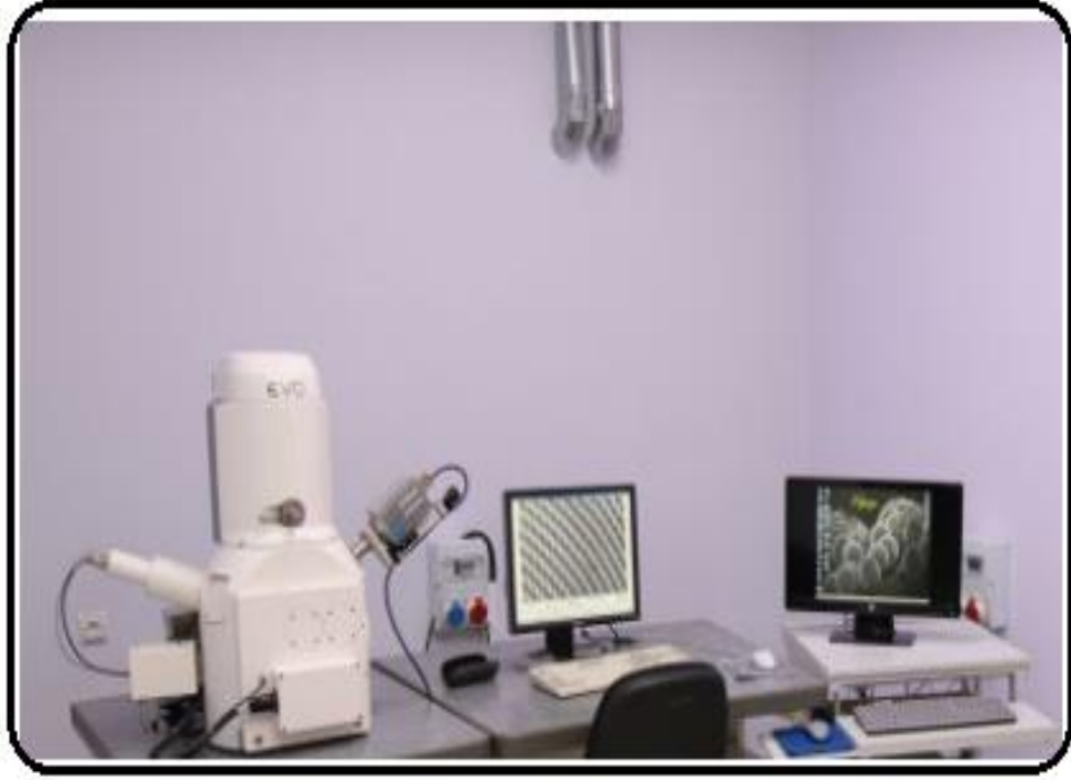
Şekil 3. 8. AgNP'lerin morfolojik yapılarının incelenmesinde kullanılan SEM cihazı görüntüsü
