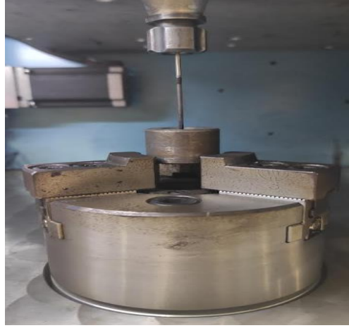
Şekil 5.8 : Nihai çapa getirme işlemi makine görüntüsü.
