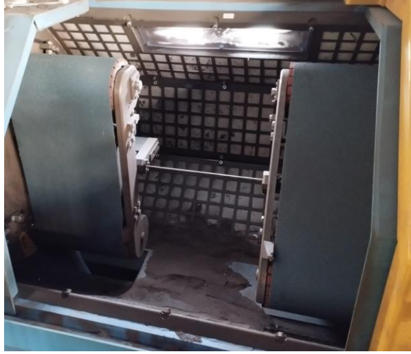
Şekil 2.4 : Zımpara tip mekanik yüzey temizleme ünitesi gösterimi.
