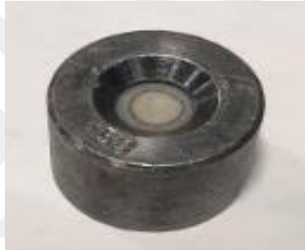
Şekil 5.9 : Elmas sıvısı ile doldurulmuş matris görüntüsü.
