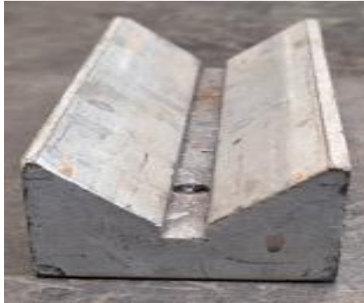
Şekil 7.5 : Yüzey Pürüzlülük Açılı Ölçüm Tablası.
