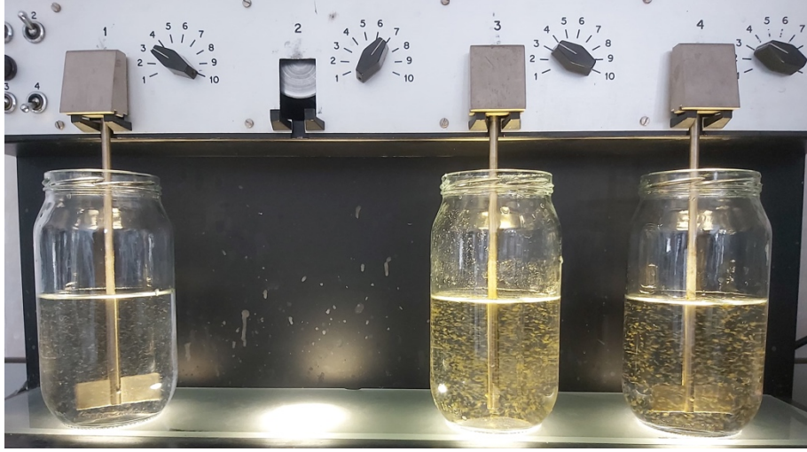
Şekil 3.2. Flokülasyon esnasında jar testi düzeneği
