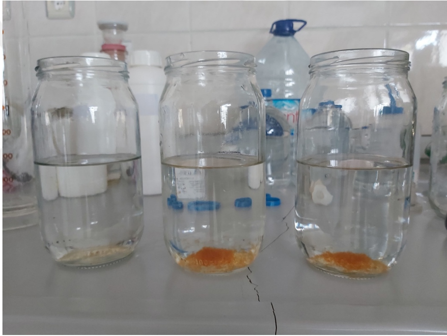
Şekil 3.3. Çökeltim esnasında jar testi düzeneği
