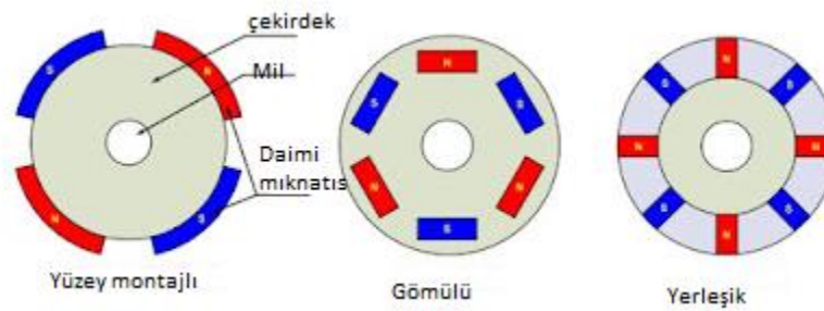
Şekil 2.8: Mıknatısın Yerleştirilmesine Göre FDAM Yapıları
