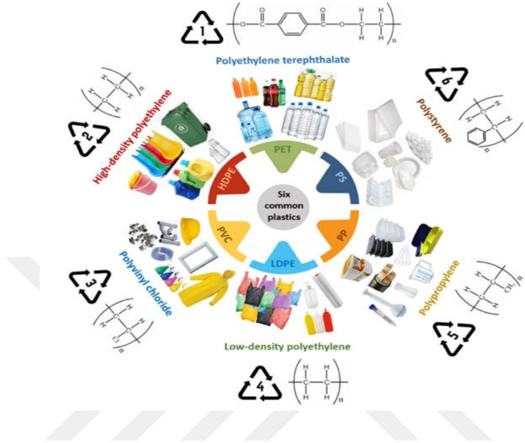
Şekil 2.1. Geri dönüşüm kodları ve kimyasal yapılarıyla birlikte piyasada bulunan altı yaygın plastik (Chang S., 2023).
