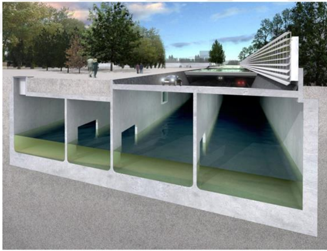
Şekil 2.16 : Museumpark'ın yanında bulunan yeraltı otoparkının rampasının altına inşa edilen su rezervuarı (Url-9).
