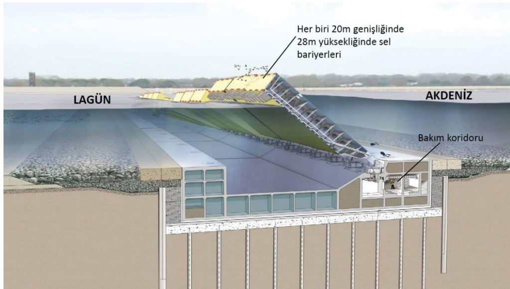
Şekil 2.19 : MOSE bariyerlerinin kesit detayı (Url-12).
