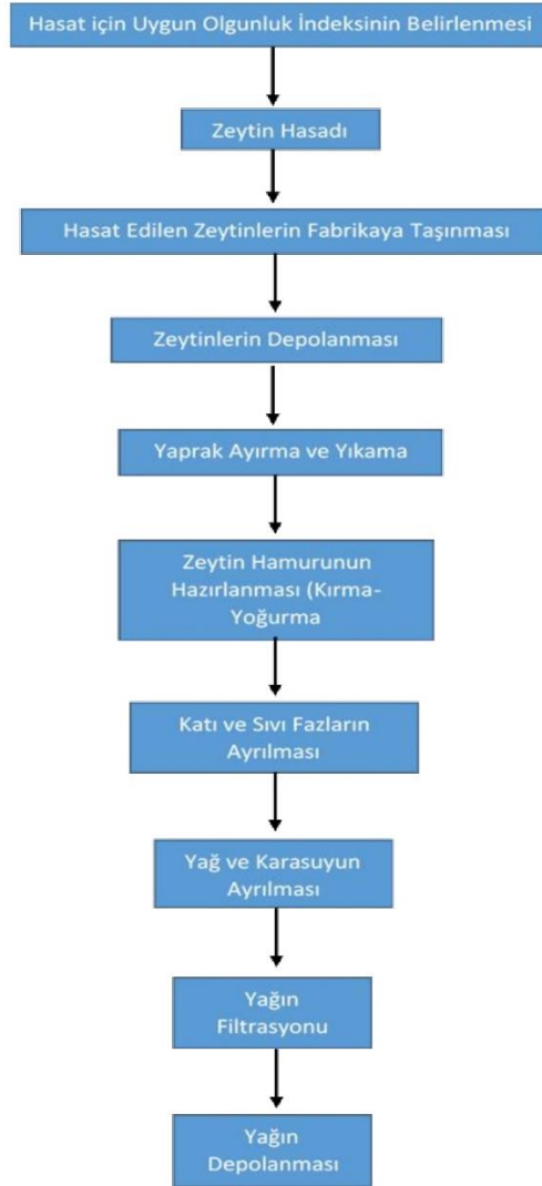
Şekil 2.5 Natürel zeytinyağı üretim akış şeması.
