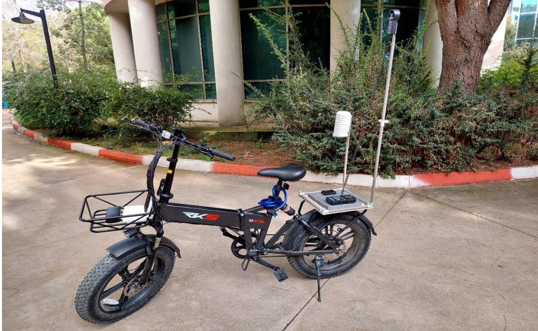
Şekil 3.10. Mobil ölçüm aracı. Arka kısmına anemometre, GPS cihazı ve termometre yerleştirilmiştir
