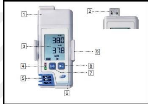
Şekil 3.3. Log 200 Dijital Veri Kaydedici tuş dizilimi (sağda) ve cihazın teknik özellikleri (solda)
