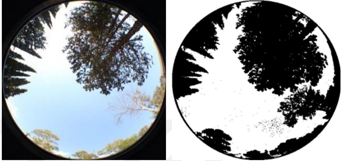
Şekil 3.14. Gökyüzü görünüş faktörü için kenar boşlukları kırpılmış ham fotoğraf (solda) ve monokromatik görüntü (sağda). GGF değeri: 0,755
